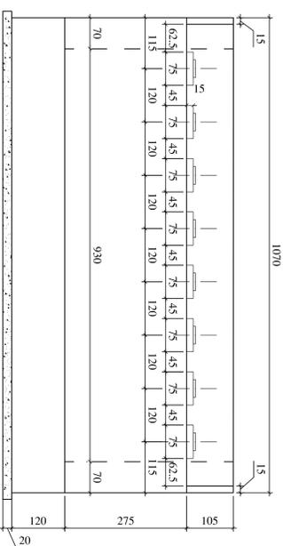
SEZIONE LONGITUDINALE IMPALCATO scala 1:50
